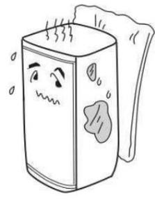
Плохое рассеивание тепла, пожалуйста, проверьте, есть ли достаточно места для охлаждения вокруг продукта
